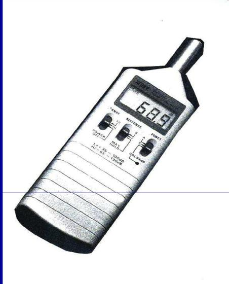
Il livello dell'**INTENSITA'** DEL RUMORE si misura con il **FONOMETRO**; lo si colloca in postazione fissa per le misure "ambientali" e si segue l'operatore (a 10 cm dall'orecchio) – "metodo ombra"- per i livelli personali
